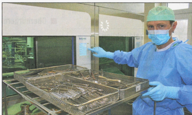
Jonny Sillack, im „unreinen“ Bereich der ZSVA beim Bestücken der Instrumentenwaschmaschine. Nach Beendigung des Waschprogramms wird das Instrumentarium auf der gegenüberliegenden „reinen“ Seite entnommen und für die Sterilisation vorbereitet.
