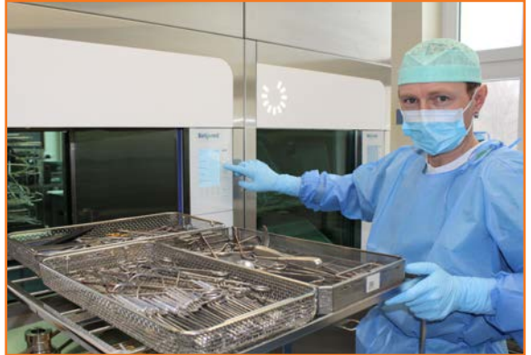
Jonny Sillack im „unreinen“ Bereich der ZSVA beim Bestücken der Instrumentenwaschmaschine. Nach Beendigung des Waschprogramms wird das Instrumentarium auf der gegenüberliegenden „reinen“ Seite entnommen und für die Sterilisation vorbereitet.
